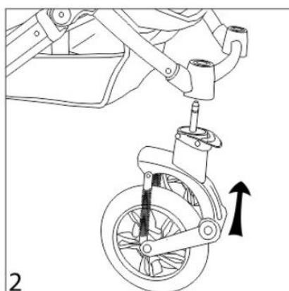
Como se muestra en la Fig.2, inserte cada una de las ruedas dentro del eje delantera hasta escuchar un “click”
