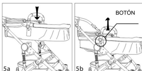
El moisés viene pre ensamblado. Sólo encástrelos en los adaptadores como se ve en las Fig. 5a y 5b.
