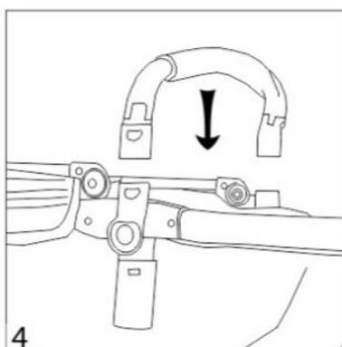
Como se muestra en la Fig.4, inserte cada uno de los extremos del barral en la estructura del coche hasta escuchar un “click”.
